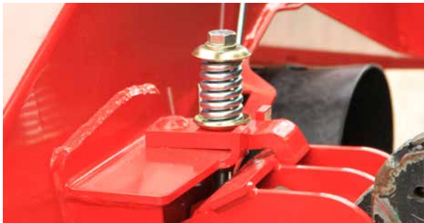
Akadályba ütközéskor a NonStop BreakAway rendszer aktiválódik,
