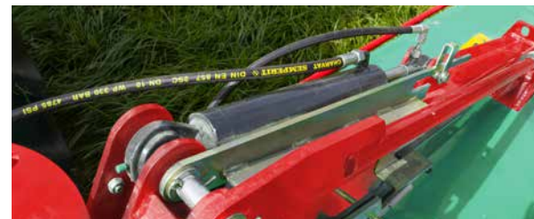
Kiemelés hidraulikusan a tábla végeken.
