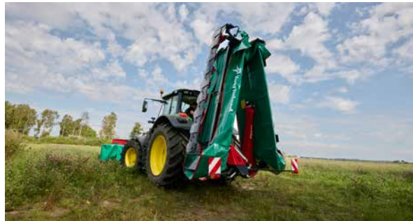
Függőleges szállítási helyzet a jó súlyeloszlás érdekében.
